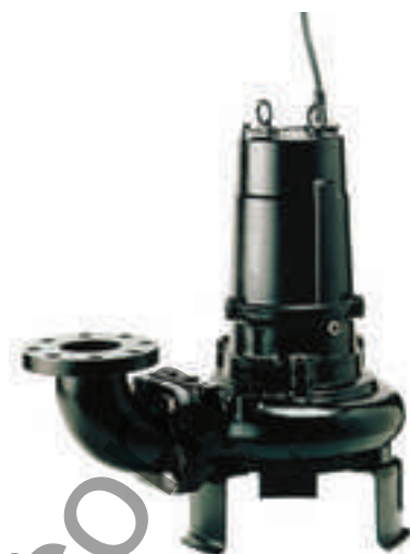
Вихров импелер, широк корпус на помпата и 4-полюсен ел. мотор не допускат задръстване.
